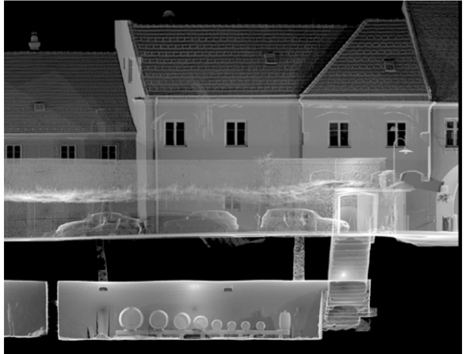
Dorferneuerungsprojekt „Kulturkeller Imbach“: Querschnitt durch die Kelleranlage im 3D-Laserscan. (Foto: Bogensberger-Vermessungen/www.diebauforscher.at)
